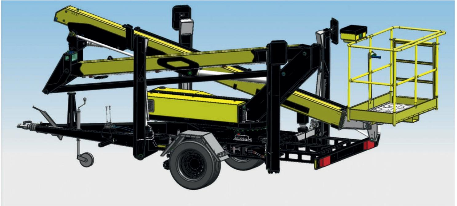
Полуприцепной гидравлический подъемник коленчато-телескопический ПКТ-16 используется во время проведения отделочных, монтажных, работ по обслуживанию различных устройств на высоте, в том числе монтажа рекламных щитов и вывесок, систем видеонаблюдения и пожарной безопасности, слаботочных электрических систем и др. и предназначен для подъема и спуска людей (с рабочими материалами) к месту производства работ на высоту до 16 м.
