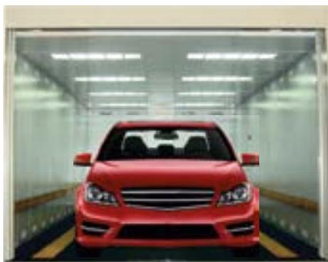
Разработан грузовой лифт ГВ3015 грузоподъемностью 3200 кг, со скоростью движения 0,5 м/с для перевозки автомобилей с автоматическими телескопическими дверями кабины и шахты. Так же выпускаются специальные грузовые лифты грузоподъемностью 3200 кг и 5000 кг с возможностью транспортирования автомобилей с дверями ручного открывания. Они используются как в многоуровневых гаражах, так и автоцентрах.
