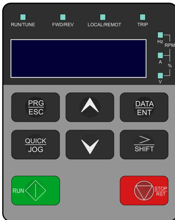
Рисунок 6.1 – Общий вид цифрового пульта
