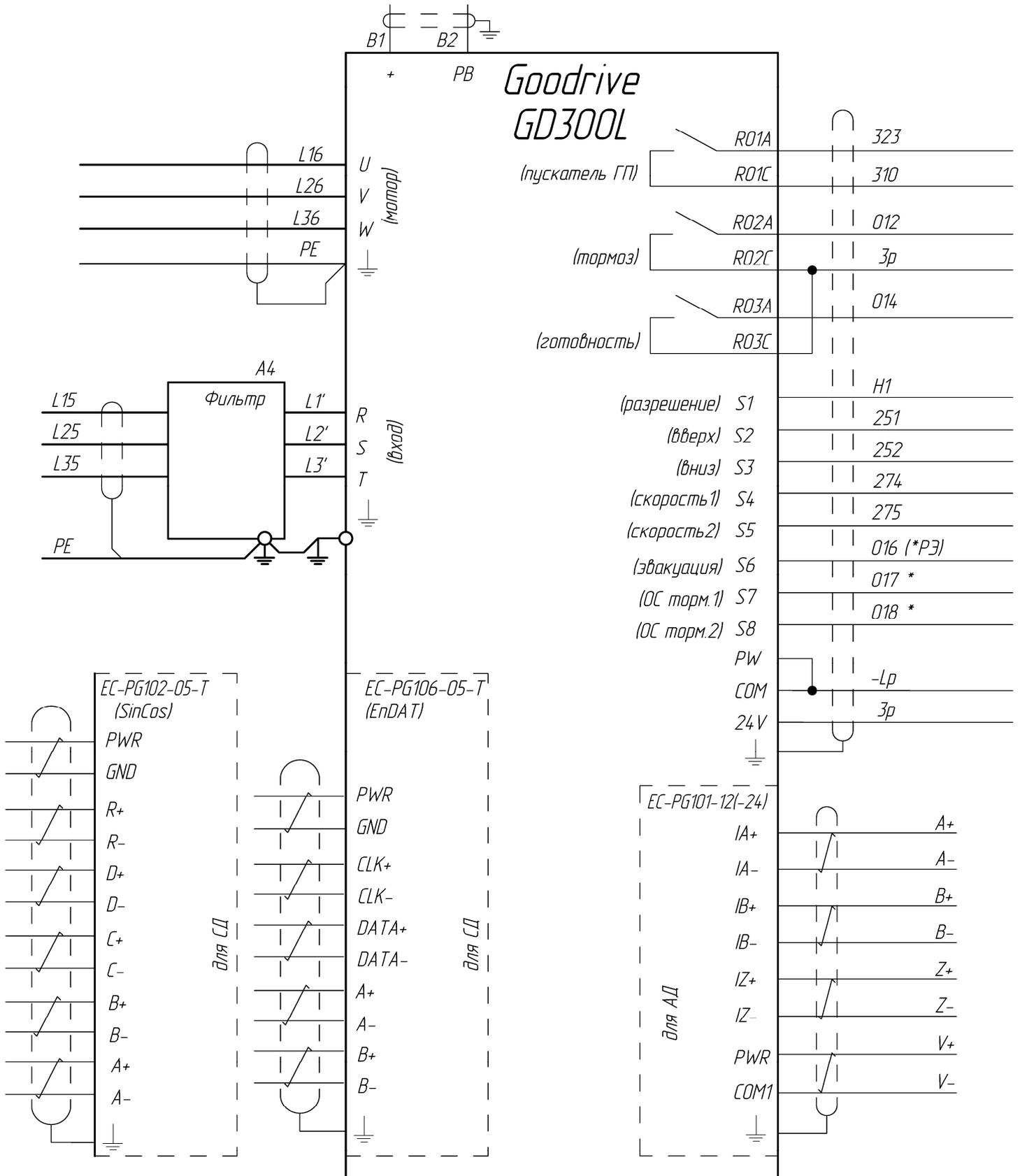
Перемычку 24V-PW удалить, для подключения энкодера дополнительно см. схему Э4 лифта
