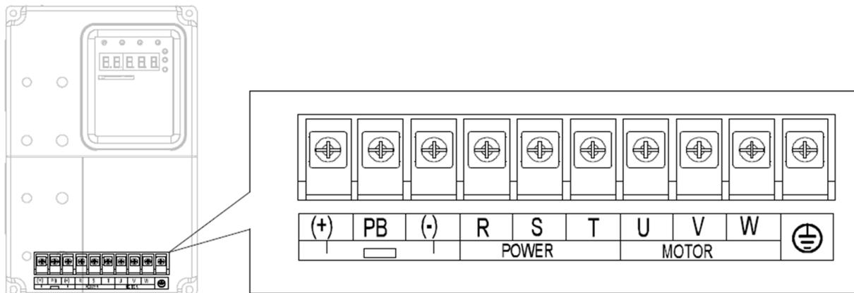
Рисунок 5.1 Общий вид силовых клемм (4кВт-5.5кВт)
