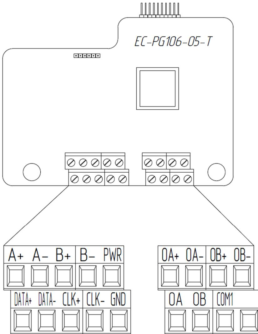
Рисунок 5.7 – Плата подключения энкодера EC-PG106-05-T
