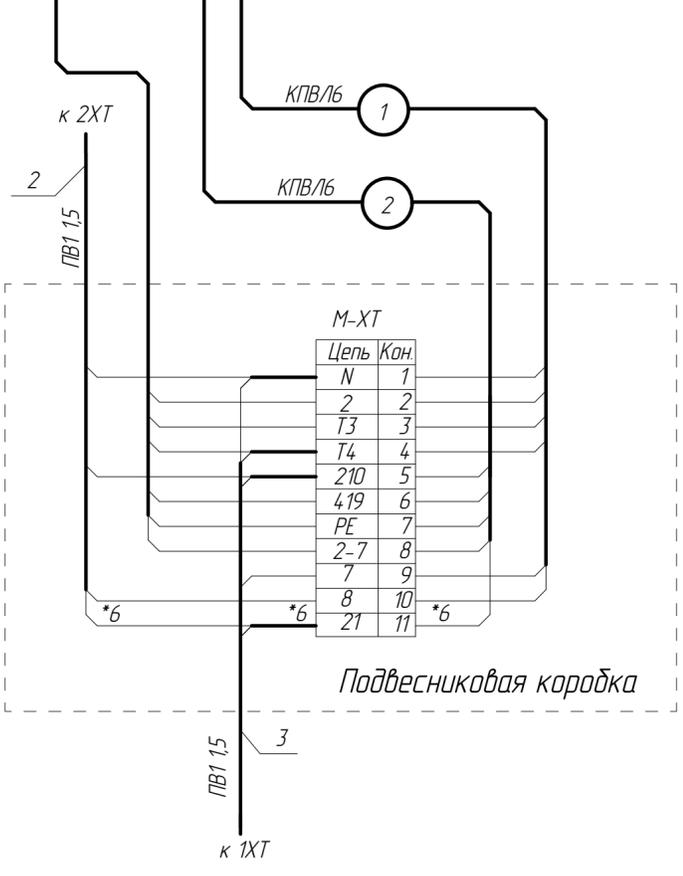
1. Схема выполнена для грузовых лифтов г/п до 250 кг, скоростью до 0,5 м/с на 2 остановки с распашными или вертикально-раздвижными дверями.
